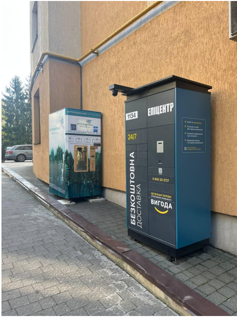
Рис. 11 Водомат та поштошат розташовані на похилій площині, доступ маломобільних груп населення обмежений наземним парпетом. Об'єкти розташовані без блокування один до одного та без узгодження колірної гами.
