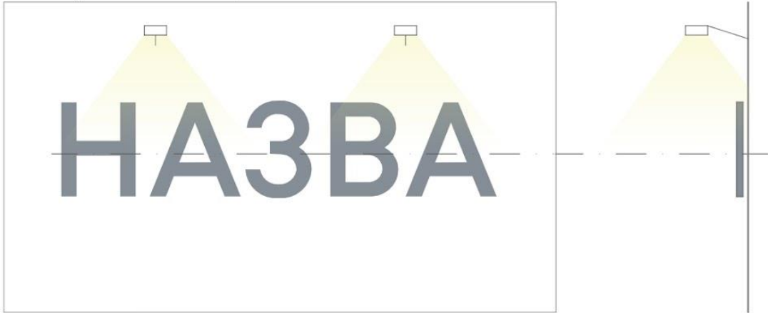
Вивіска підсвічена зовнішніми кронштейнами
